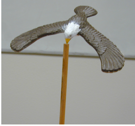
Figura 3: Tentetieso águila, con los contrapesos ocultos en los extremos de las alas. La distancia desde el punto de apoyo hasta el centro de gravedad, se estima que es D = 1,0 \pm 0,1 cm. La distancia d_1 desde el pico hasta el primer eje de giro se estima en d_1 = 7,5 \pm 0,5 cm, mientras que la distancia d_2 de las alas hasta el segundo eje de giro se estima que es d_2 = 2,5 \pm 0,2 cm.
