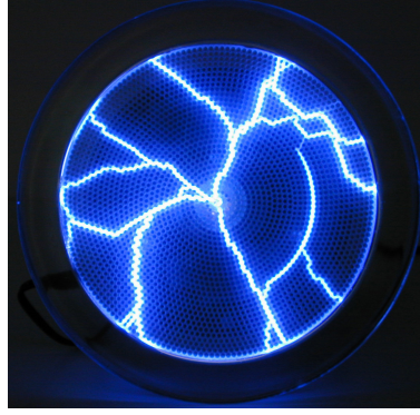
Figura 25: Luz aleatoria . Un punto central de alta tensión produce descargas que van buscando la parte exterior del disco a través de una matriz del tipo del camino aleatorio, cambiando constantemente la trayectoria de los rayos.
