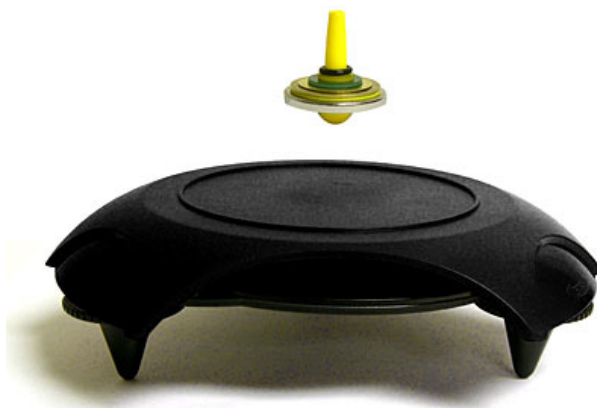
Figura 6: Levitron (cortesía de ThinkGeek, www.thinkgeek.com ). Una pequeña peonza, bien equilibrada mediante pequeñas arandelas, se estabiliza por rotación y levita sobre el campo magnético complejo creado por una particular disposición de imanes ocultos en la base del aparato.
