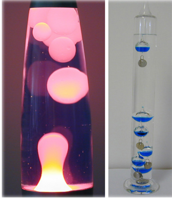
Figura 13: (i) Lámpara de lava . Los glóbulos de cera caliente ascienden cuando su densidad se hace menor que la del líquido superior. (d) Termómetro de Galileo . Bolas cerradas y semillenas de líquido flotan o hunden en función de la temperatura del líquido que las contiene.
