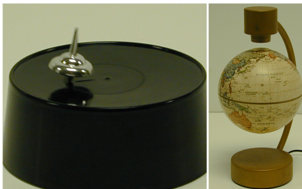
Figura 23: (i) Peonza sin reposo . Una vez puesta en movimiento, ésta peonza permanece girando de forma (casi) indefinida. (d) Globo terráqueo levitante . La bola flota, controlada por un dispositivo electrónico. Si el conjunto se coloca encima de un sensor de fuerzas se comprueba que el peso total es el mismo tanto si la bola se encuentra unida por su imán al cabezal superior como si aquella levita en equilibrio (Tercera Ley de Newton).
