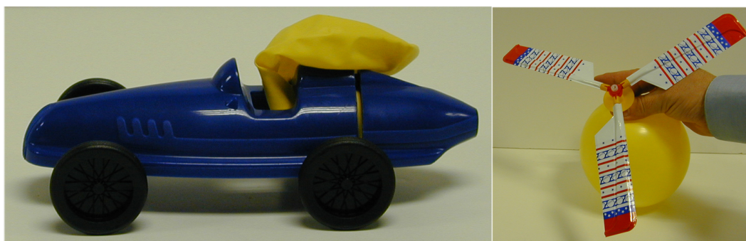
Figura 9: (i) Coche movido por globo . Vehículo movido por un globo hinchado unido a él que se deshinch a través de un orificio. (d) Helicóptero de globo . El giro del helicóptero es producido por el globo al deshincharse a través de un distribuidor que envía el aire a través de sus alas, con contienen un tubo hueco con un codo. Para permitirle ascender, sus alas tienen una cierta inclinación respecto de la horizontal.
