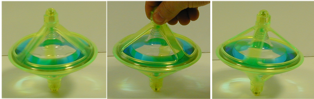
Figura 4: Peonza de agua . Al girar, el agua del depósito interior se desplaza hacia las paredes más alejadas del eje de giro. Si se detiene la carcasa exterior, el depósito interior y el agua continúan girando. Si poco después se libera la peonza, la carcasa vuelve a girar.
